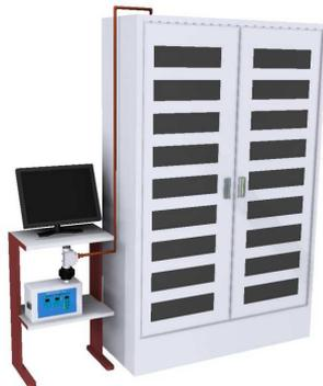
槽内の温度が高温（60度以上）に達するリチウムイオン電池充放電試験装置の異常検知においては、チューブの代わりに細い銅管を検知器に取り付け、槽内の煙を吸引します。熱伝導率の高い銅管を使用することで、吸引した煙を検知器に影響を与えない温度まで冷却します。
