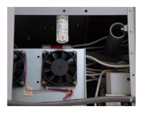
クリーンルーム内に設置されている製造装置等 の非常に狭い電源部に設置が可能です。又 本製品は小型ファンを内蔵しているため冷却 ファン等で希釈された煙粒子をすばやく検知す る事が可能です。
