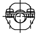
5. ⑧ (六角穴付き止めねじ) を六角棒スパナ (呼び 1.5) で締めつける (M3 締め付けトルク  $0.6\text{N}\cdot\text{m}$  / 参考値)。
