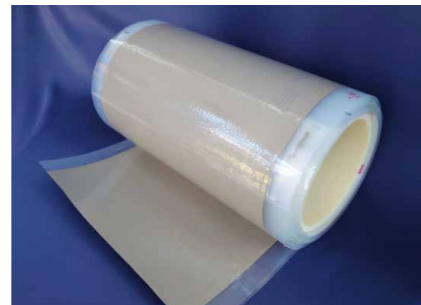
CMC (セラミックス複合材料) 中間製品 CMC (Ceramic Matrix Composite) Intermediate Product
